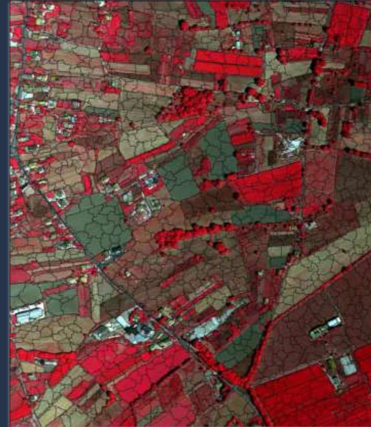
All'interno del software, **la segmentazione** (divisione dell'immagine in oggetti in base alle diverse proprietà spettrali e/o geometriche) viene ottenuta principalmente mediante l'algoritmo "multiresolution segmentation": I parametri che intervengono sono: **scale** (scala di segmentazione), **shape** (quanta importanza ha la regolarità dei bordi rispetto alle differenze spettrali) e **compactness** (quanto gli oggetti ottenuti debbano essere compatti).
