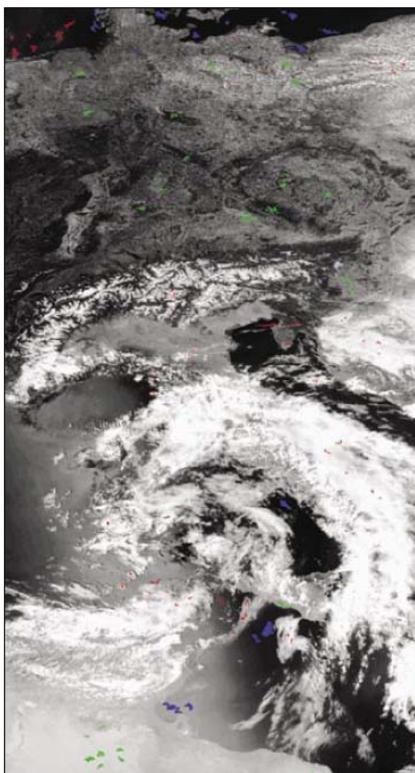
Figura 1: canale1 VIS di AVHRR (0.63  $\mu\text{m}$ ). Le aree campione per la classificazione NN sono colorate. Le vegetazione appare scura e le nuvole chiare
