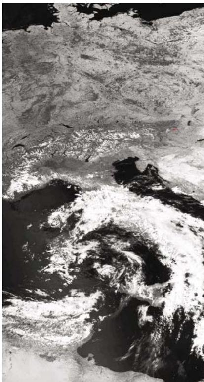
Figura 2: canale 2 NIR (0.91  $\mu\text{m}$ ). Le vegetazione appare più chiara che nel canale VIS
