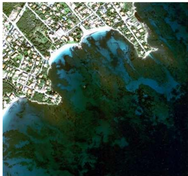
Fig. 2. Immagine pansharpened ortorettificata del 2021 senza correzione batimetrica (in alto) e con correzione batimetrica (in basso). L'effetto dell'utilizzo della batimetria sposta e modifica la forma del fondale marino.
